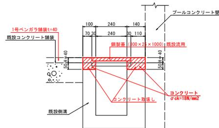
※計画天端高は、既設コンクリート舗装高+H=40mmを標準とし、かさ上げ高Hを変更すること。
