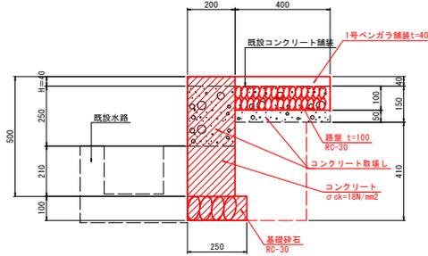
※計画天端高は、既設コンクリート舗装高+H=40mmを標準とする。
