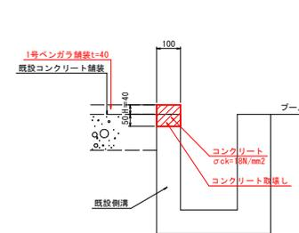
※計画天端高は、既設コンクリート舗装高+H=40mmを標準とし、かさ上げ高Hを変更すること。
